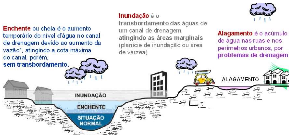
Figura 20. Ilustração dos conceitos: Enchente, Inundação e Alagamento. Fonte IU
