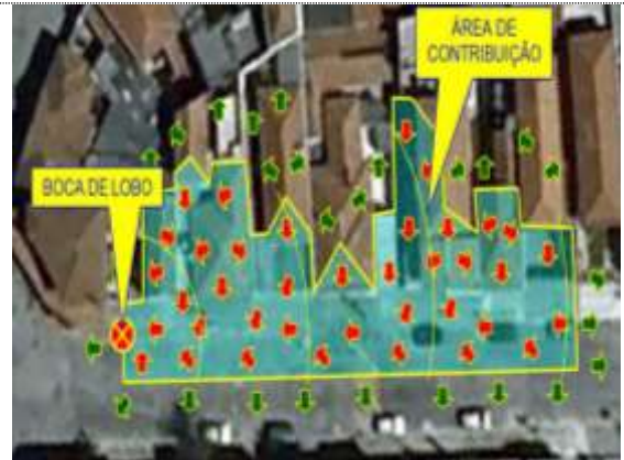
Figura 26. Delimitação das águas que fluem para o ponto de interesse. Fonte IU.
